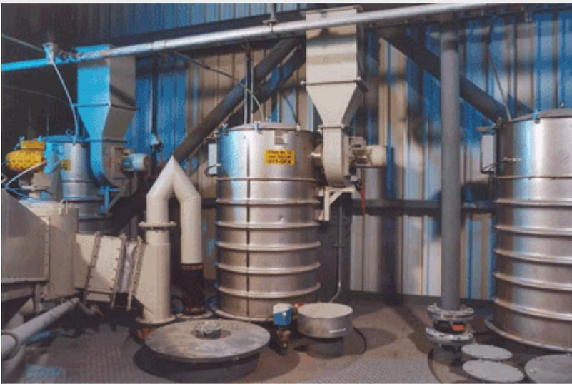
Für eine Mischanlage in einer Zementfabrik wurden mehrere Silos für Zement, Kalksteinmehl, Flugasche und Hüttensandmehl installiert. Diese Silos werden über Becherwerke mit den Produkten befüllt.
