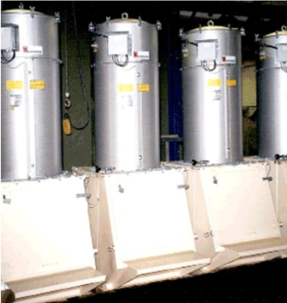
Für eine Farbenfabrik wurden 20 Sackentleerungsfilter, bestehend aus einer Sackeinschütze und einem **druckluftgereinigten Patronenfilter**, geliefert. Alle Sackentleerstationen werden zentral über einen gemeinsamen Ventilator besaugt. Die pneumatische Abreinigung der Filterpatronen wird über einen Näherungsschalter, der durch die Sackeinschüttgossentür initiiert wird, automatisch ein- bzw. ausgeschaltet.
