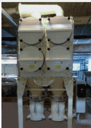
Ein **Patronenfilter vom Typ MPR** sorgt mit der Stauberfassung an mehreren Absaugstellen innerhalb einer Tablettenpresse für die saubere Produktion der Arzneien.
