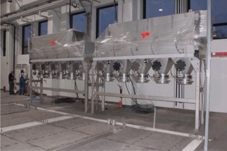
Die Entstaubung von zwei Edelstahl-Caissons, in denen radioaktive Abfälle zerlegt, sortiert und aufgearbeitet werden, erfolgt durch zwei baugleiche **Kassettenfilter vom Typ INFA-MICRON MKR 5/20-4/20**. Für ein höheres Abscheidevermögen des leicht nuklear belasteten Staubes wurden die Kassettenfilter mit zwei Filterstufen ausgelegt.
